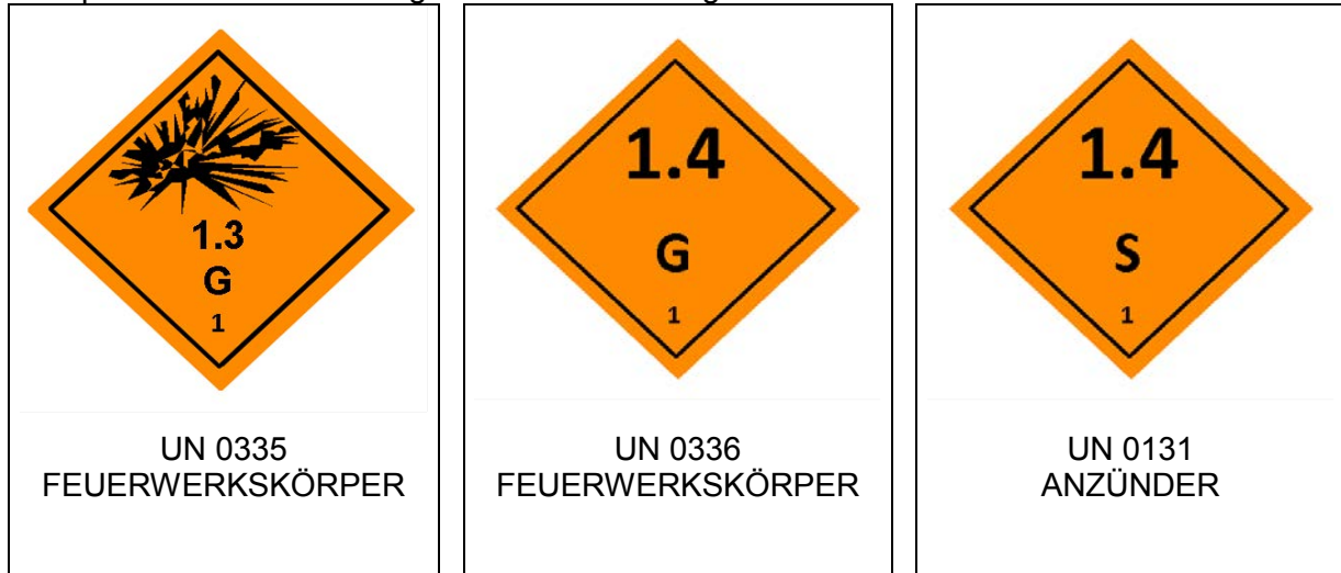
Abb. 1: Gefahrzettel für Feuerwerkskörper z.B. Kugelbomben mit Sterneffekt (Kaliber <180mm) oder Batterien
